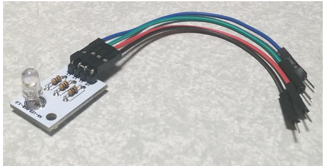
ピン端子に ケーブル4本を接続する L0:GND、L1: 赤、L2: 緑、L3: 青
