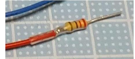
※写真では、熱収縮チューブを使って隣の線との接触防止(絶縁)
