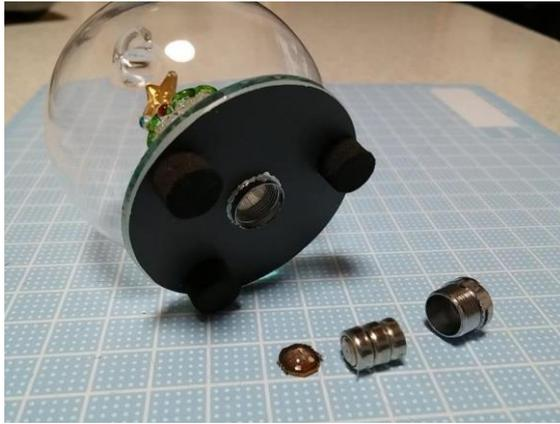
①底の電池部分を空けて最初から付いてたLED基板を外すとちょうどいい穴が開く。
